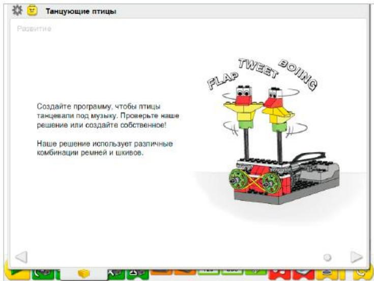
В данном занятии не требуется отклоняться от инструкций по сборке. Чтобы изменить характер движения птиц, достаточно по-другому скомбинировать систему шкивов и ремней.
