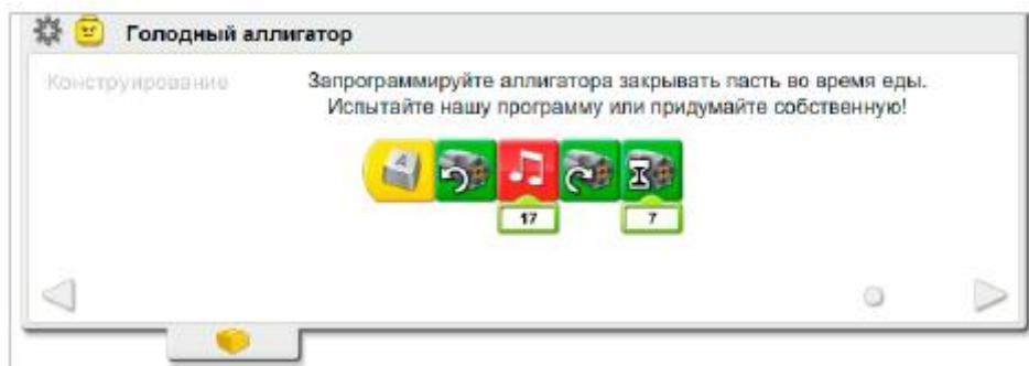
В программе «Голодный аллигатор» для включения модели используются клавиши клавиатуры (в английской раскладке). Блок «Начать нажатием клавиши» включает мотор против часовой стрелки (чтобы закрыть пасть) при нажатии на клавиатуре клавиши A.
