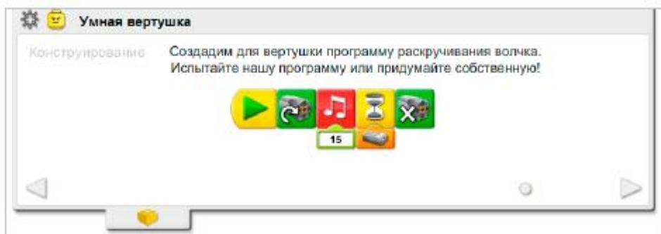
Программа включает мотор и воспроизводит Звук 15 (звук работающего мотора), после чего ожидает, когда датчик расстояния сообщит о том, что устройство для запуска поднято и волчок освобождён. После этого программа выключает мотор.
